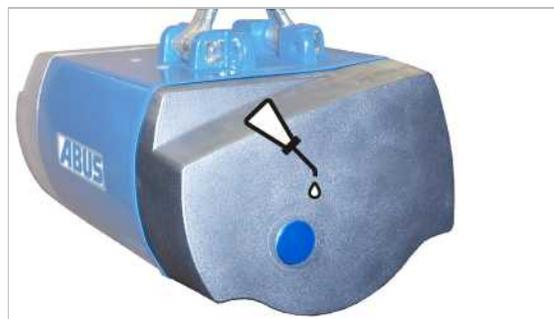
Lubrificação pela fábrica com lubrificante de denominação normatizada CLP ISO VG 460 DIN 51502.
